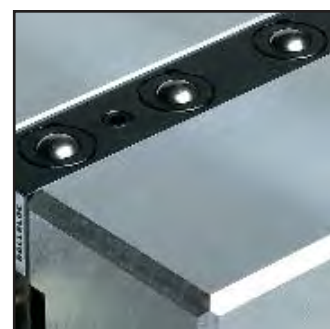
La tavola pressa è attrezzata con inserti di sollevamento ROLLBLOC durante l'utilizzo delle sottopiasstre.
