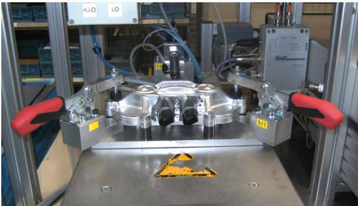
Attrezzo orizzontale Nr. 6830 utilizzato su un dispositivo di controllo tenuta. L'elemento bloccato è un componente per la regolazione dell'albero a camme.
