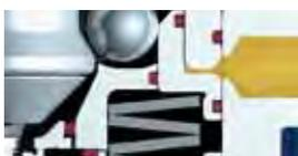
> Se la guarnizione del pistone diventa non ermetica, il vano molle si riempie velocemente di olio. La conseguenza di ciò è: il pistone si blocca e non è più possibile aprire il modulo. A questo punto sarebbe indispensabile distruggere il dispositivo serrato o il modulo di bloccaggio. Qui il sistema di sicurezza brevettato fa sì che l'olio nel vano molle possa fuoriuscire e che il pistone possa essere nuovamente azionato.
