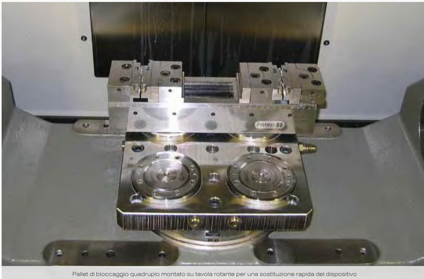
Pallet di bloccaggio quadruplo montato su tavola rotante per una sostituzione rapida del dispositivo
