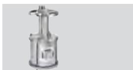
> Moltiplicatore di pressione idraulico: traduce la pressione pneumatica in idraulica con un rapporto di 1:8 per aprire i moduli di bloccaggio idraulici. Dispositivo pneumatico di aumento della pressione: serve a rafforzare la pressione pneumatica in un rapporto di 1:2 nei moduli di bloccaggio pneumatici e compensa le oscillazioni di pressione nella linea di alimentazione.
