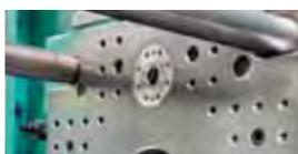
> In particolare in caso di sostituzioni frequenti di stampi per iniezione, i costi per una soluzione punto zero con queste macchine si ammortizzano in tempi molto brevi. Rispetto alle staffe, il bloccaggio viene effettuato in modo semplice e veloce premendo un pulsante.
