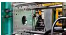
> Nella versione standard la massima temperatura di esercizio è di 80°C. E' sempre possibile richiedere moduli di bloccaggio per l'utilizzo a temperature più elevate.
