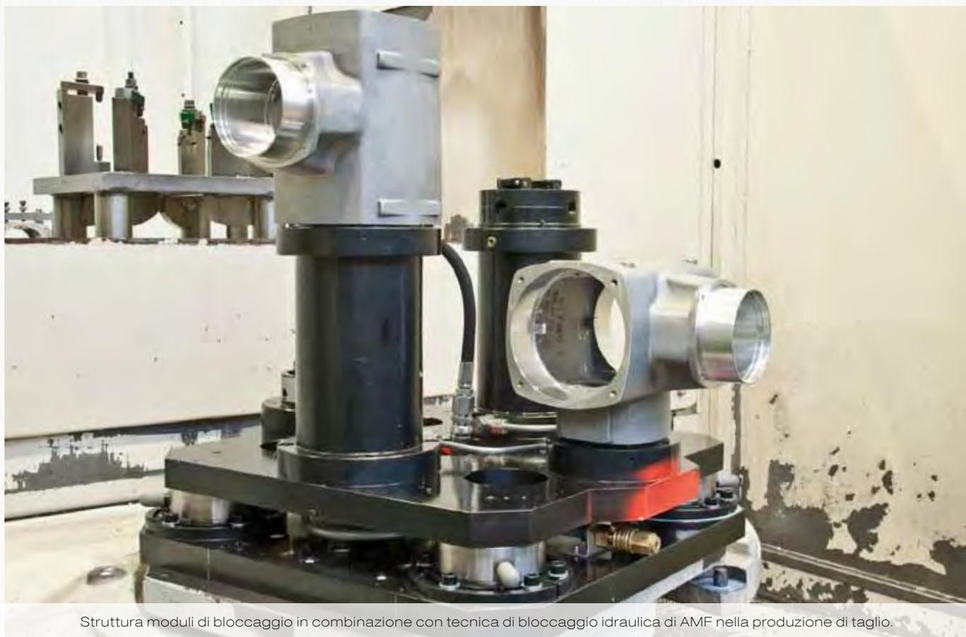
Struttura moduli di bloccaggio in combinazione con tecnica di bloccaggio idraulica di AMF nella produzione di taglio.
