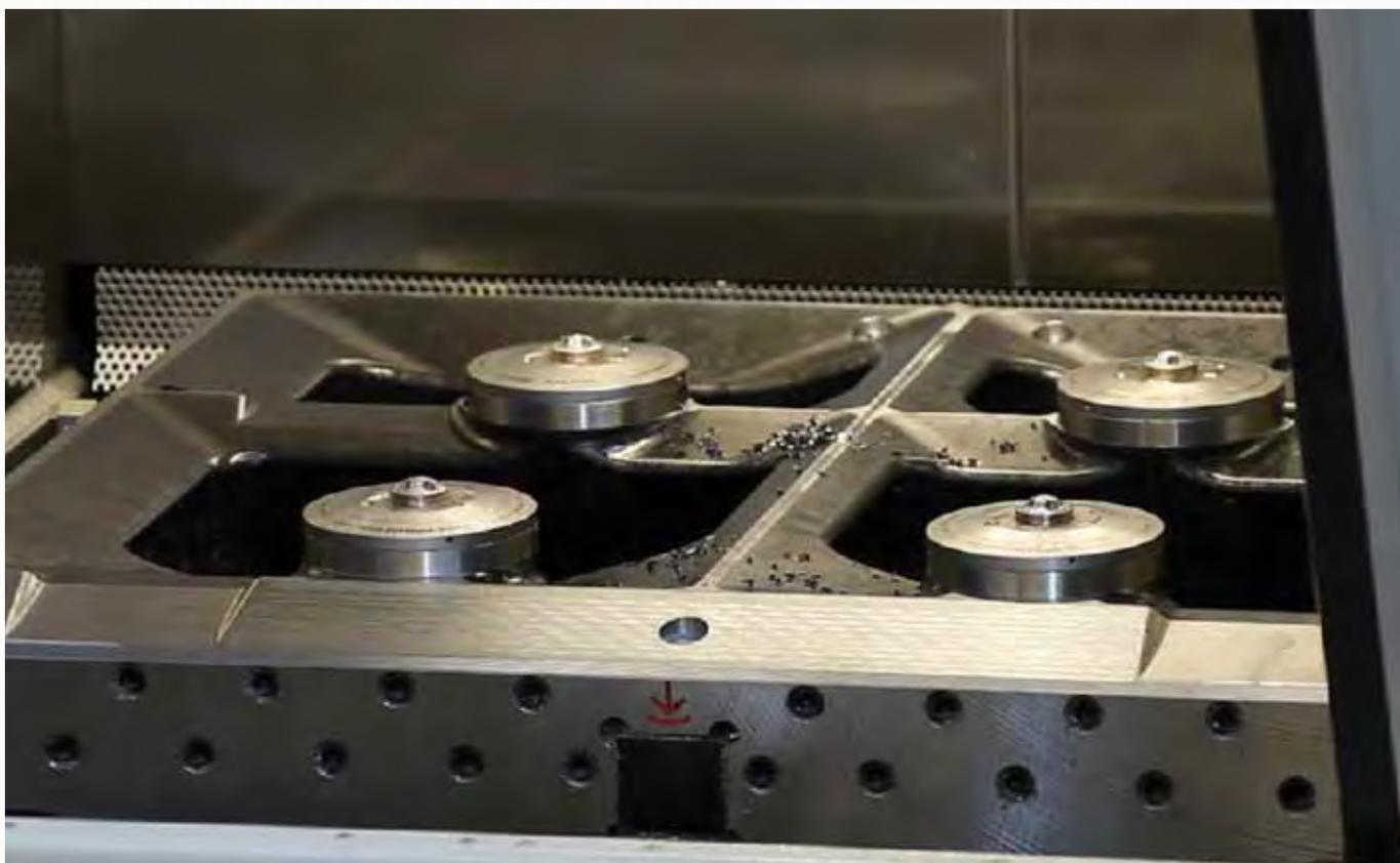
Modulo di bloccaggio high-end „Turbina“ (n. ordine 420919) in utilizzo in un processo produttivo completamente automatizzato con caricamento con robot.
