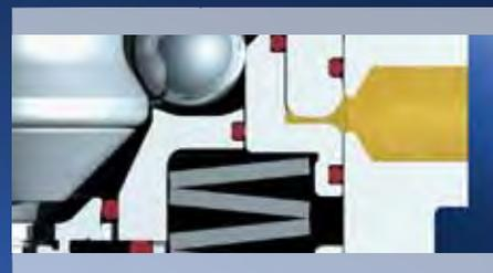
Sicurezza di processo - Il modulo di bloccaggio si apre sempre. Quindi è impossibile che si blocchi il pistone.
