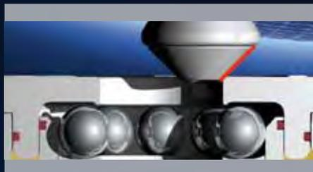
Nessuna faticosa ricerca del foro - centraggio: mediante le superfici laterali inclinate della vite di innesto del nipplo.
