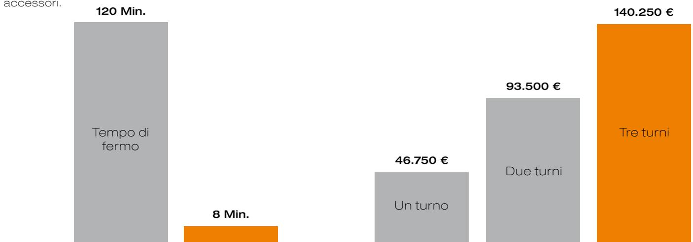
I tempi di fermo sono drasticamente ridotti da 120 min. a 8 min. grazie all'utilizzo del sistema Zero-Point AMF.
