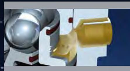
Grazie all'alimentazione fluidi laterale sono ammessi spessori ridotti della piastra e sono necessari meno fori di alimentazione.
