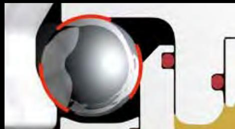
Le sfere vengono accoppiate in modo ottimale su tre lati. Così il nipplo di serraggio resta sempre serrato saldamente nel modulo.
