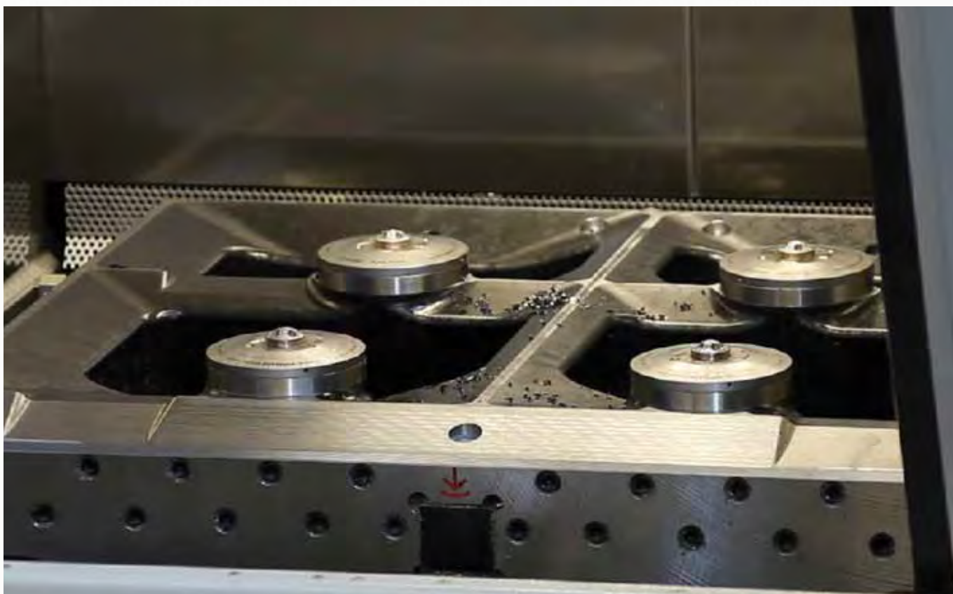
Modulo di bloccaggio high-end „Turbina“ (n. ordine 420919) in utilizzo in un processo produttivo completamente automatizzato con caricamento con robot.
