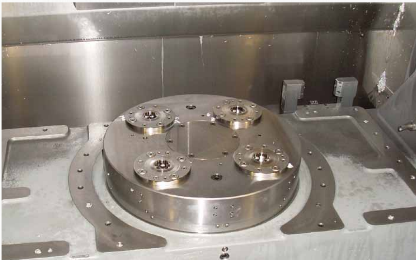
Soluzione di automazione (n. ordine 427161) con controllo di bloccaggio e appoggio e interrogazione del nipplo in utilizzo in un processo produttivo completamente automatizzato con caricamento con robot.
