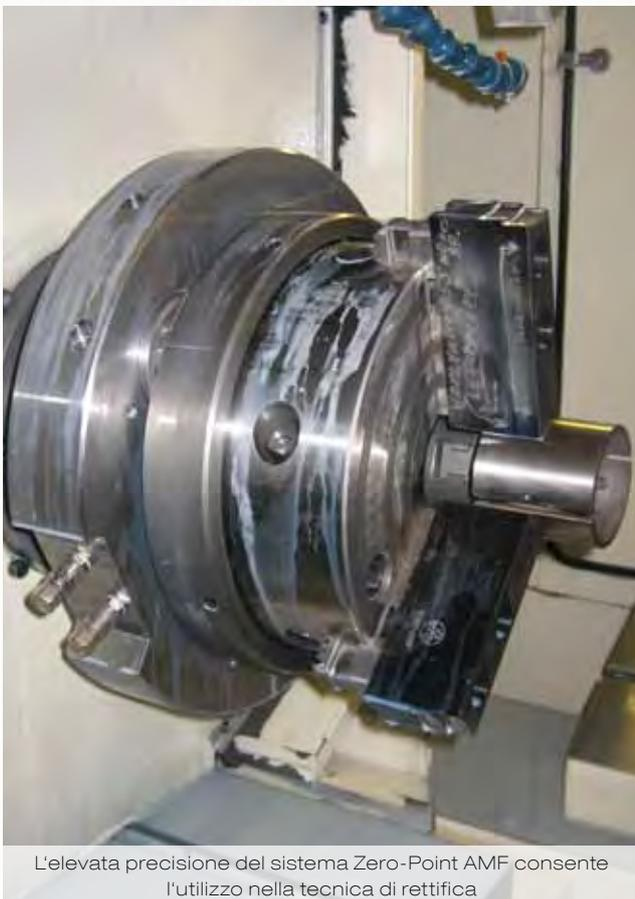
L'elevata precisione del sistema Zero-Point AMF consente l'utilizzo nella tecnica di rettifica
