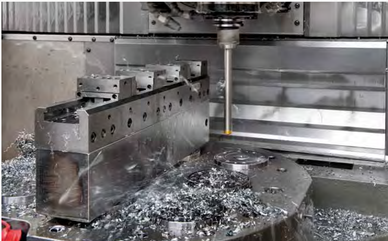
Clean stick AMF in utilizzo: pulizia automatizzata del dispositivo di bloccaggio e del tavolo della macchina
