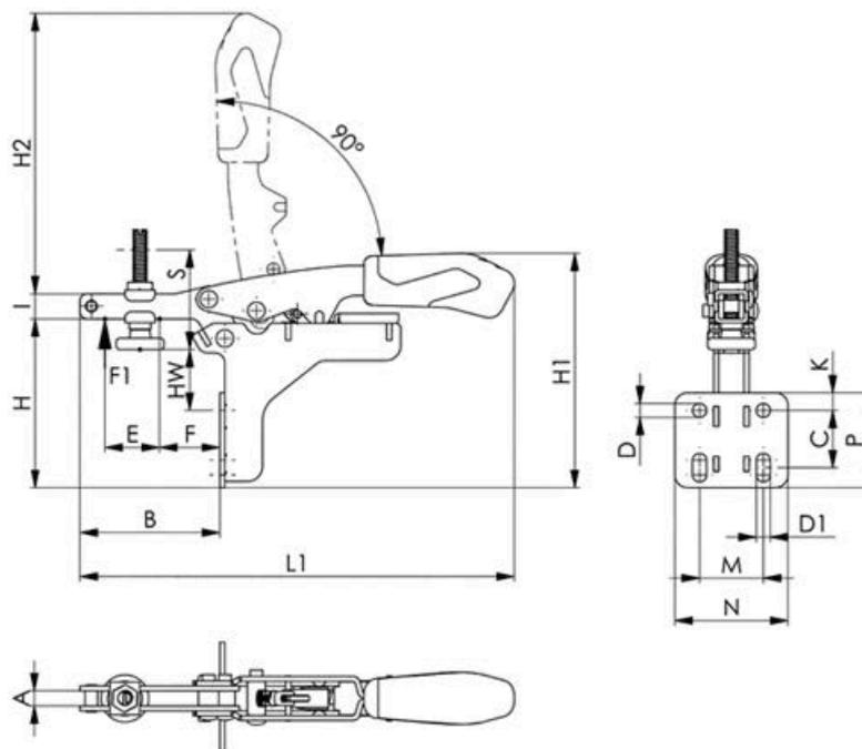
Attrezzi di bloccaggio rapido // Variable toggle clamps
