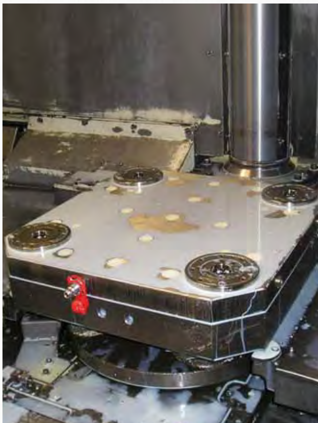
Il vano interno del modulo è completamente sigillato. Così il sistema è protetto al meglio dai liquidi e dallo sporco.
