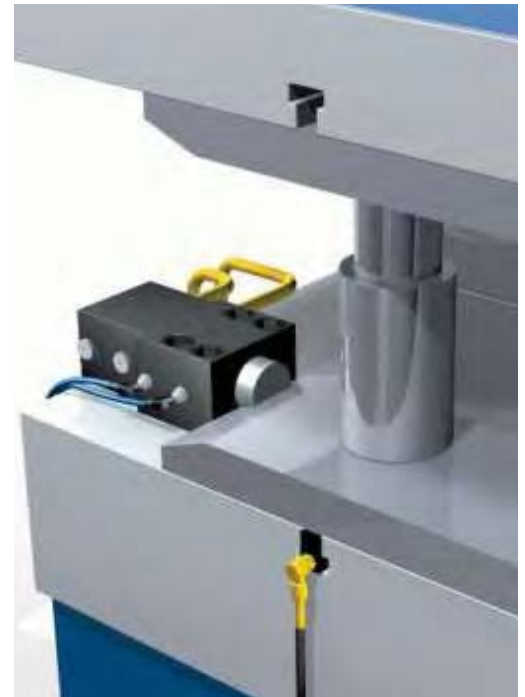
Bloccaggi idraulici ROLLBLOC a cuneo. Cilindro a doppio effetto; dopo il rilascio lasciano l'area sovrastante la piastra dello stampo completamente libera.
